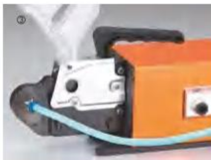
③ 用调整好的口径压接端子。 Clamp the cable end-sleeves with adjusted caliber.
